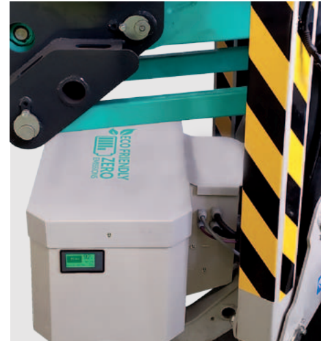
Comparto batterie litio protetto e accessibile per la gestione del ciclo di carica. Display LCD per visualizzazione stato di carica e tempo residuo batteria.
