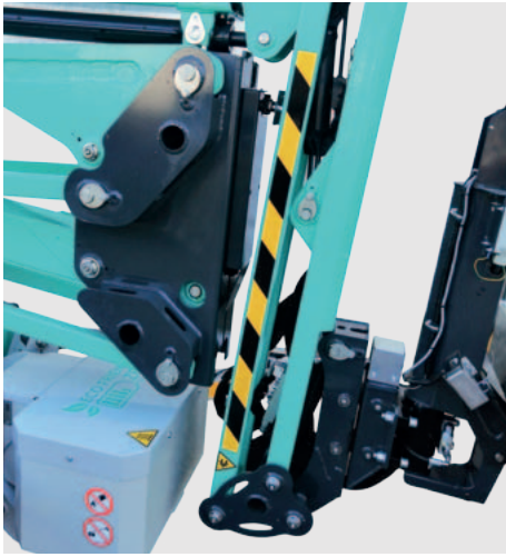
Compattezza del gruppo jib che ospita cella di carico e rotazione cesta.
