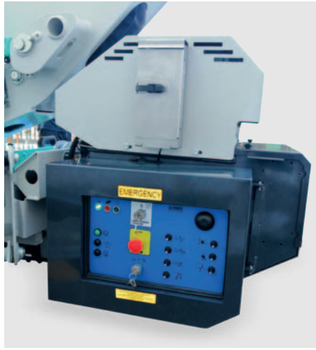
Quadro comandi a terra per operazioni di movimentazione aerea di macchina stabilizzata e per manutenzione generale.
