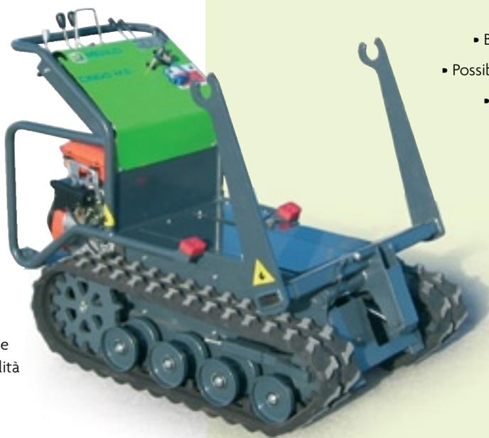
**BREVETTATO** Il sistema per l'aggancio ed il posizionamento delle attrezzature predisposte consente la sostituzione degli innumerevoli equipaggiamenti con rapidità e sicurezza.
