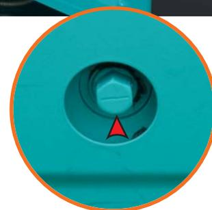
Deviatore per la funzione ausiliaria a "una o due vie" (con scarico libero al serbatoio per evitare contropressioni sull'accessorio)
