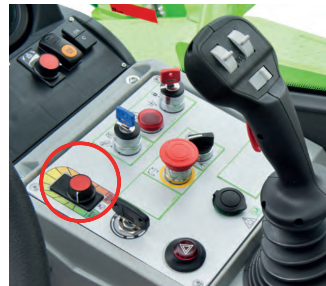
Potenziometro per l'impostazione manuale dei giri motore diesel
