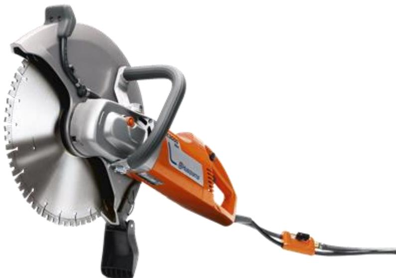
Taglio a umido e a secco con una sola macchina! Troncatrice elettrica ad umido a tutto tondo, che riduce al minimo la quantità di acqua e fanghi di taglio. Con l'unità Vac (opzionale) si può facilmente operare un taglio secco che generi una polvere minima. A differenza di altre troncatrici elettriche, il disco ruota in avanti favorendo il taglio nel materiale in modo efficiente e con un minimo sforzo da parte dell'utente.
