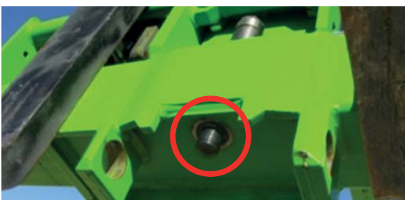
Tac-Lock: sistema di bloccaggio idraulico dell'attrezzo dalla cabina
