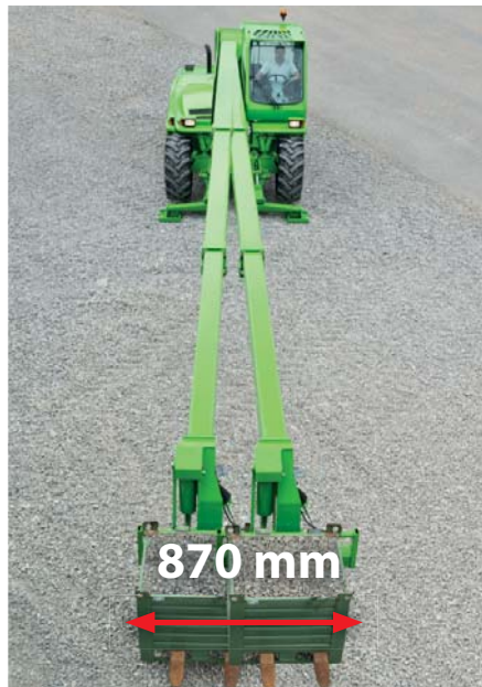
Traslazione laterale del braccio
